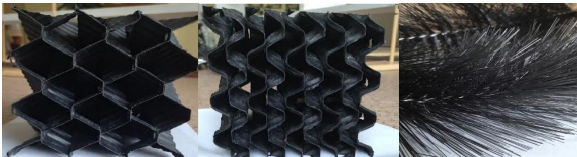
Рис. 1. Носії для іммобілізації мікроорганізмів: «Соти», «Хвиля», «Йорж» (зліва направо) Fig. 1. Carriers for microorganism immobilization: "Honeycomb", "Wave", "Brush" (left to right)
