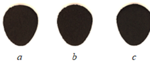
Рис. 2. Осади феритизації: a – ультразвуком (зондовим диспергатором); b – термічною; c – ультразвуком (ванна)
