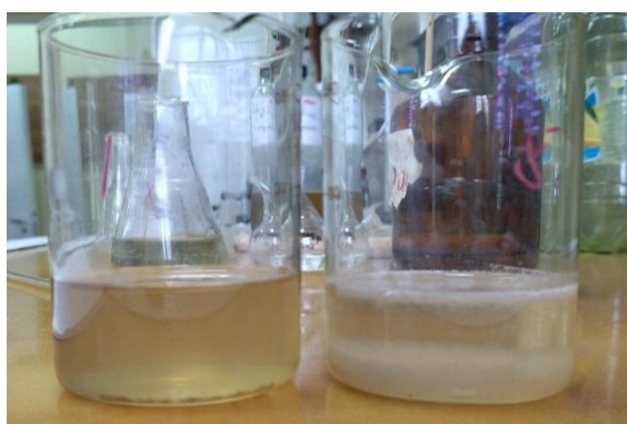
Рис. 3. Фото проб стічних вод: зліва – до коагуляції; справа – після коагуляції сульфатом алюмінію дозою 250 мг/дм 3 Fig. 3. Photo of wastewater samples: on the left – before coagulation; on the right – after coagulation with aluminum sulfate in a dose 250 mg/dm 3
