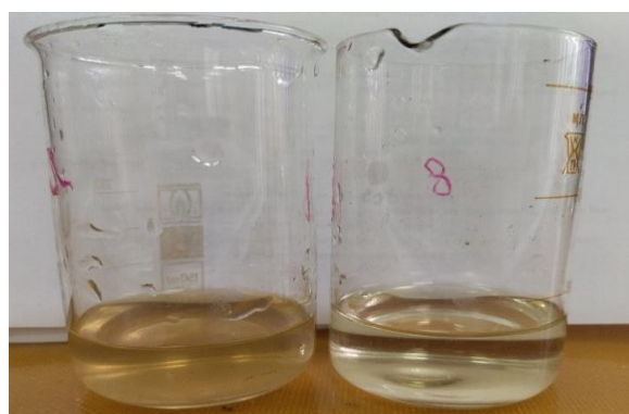
Рис. 4. Фото відфільтрованих проб стічних вод: зліва – до коагуляції; справа – після коагуляції сульфатом алюмінію дозою 250 мг/дм 3 Fig. 4. Photo of filtered samples of wastewater: on the left - before coagulation; on the right - after coagulation with aluminum sulfate at a dose of 250 mg/dm 3
