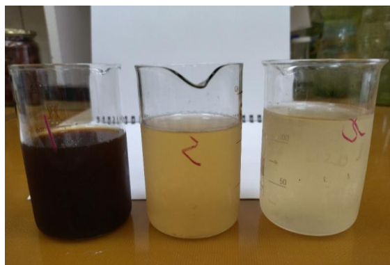
Рис. 1. Фото проб стічної води (варіант 1): 1 – на вході в усереднювач; 2 – після усереднювача; 3 – після флотатора
