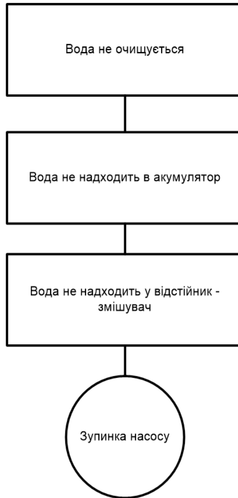
Рис. 3. Спрощене дерево відмовлень для схеми процесу електрофлотокоагуляційної очистки стічних вод Fig. 3. Simplified refusals tree for the scheme of the process of electroflocculation wastewater treatment
